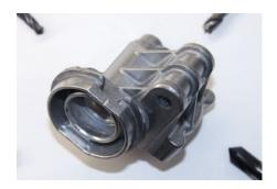
Beim Entgraten wird das zu bearbeitende Werkstück z.B. mit dem 2-Backen-Futter aufgenommen und mit Bürsten, Schleifern oder Fräsern bearbeitet. Auch komplexe Bauteile wie Zylinderköpfe, Hydraulikblöcke, oder Pumpengehäuse werden dank der Mehrachsigkeit der Entgratungszellen von gKteso entgratet. Neben Werkstücken aus Stahl, Grauguss, Aluminium, Messing oder Bronze können auch im Tiefziehverfahren hergestellte Kunststoffteile bearbeitet werden.
